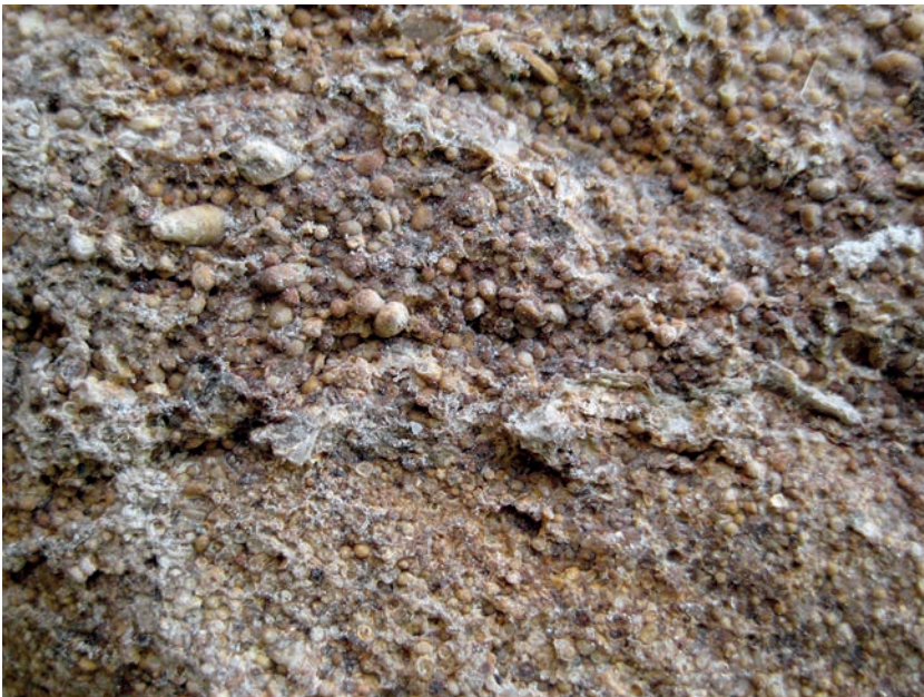
FIG. 6B Macroscopische detailopname van een stuk steen van Marquise met slecht gesorteerde oöiden of kalkbolletjes. De gemiddelde grootte van de kalkbolletjes bedraagt ongeveer 1 mm.
