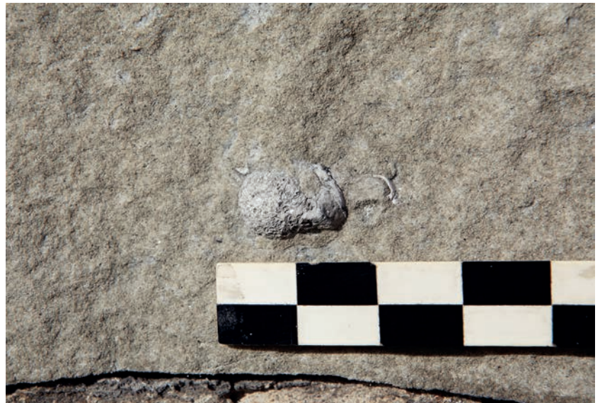
FIG. 18 Macroscopische detailopname van een fijnkorrelig zandig beige facies van de Baincthun steen met een groot afgerond gesteentefragment (kei) bestaande uit oölitische kalksteen. Kerktoeren van Oostkerke. Macroscopic close-up of fine-grained sandy beige facies of Baincthun stone, enclosing a large rounded fragment (pebble) of oolitic limestone. Church tower of Oostkerke.
